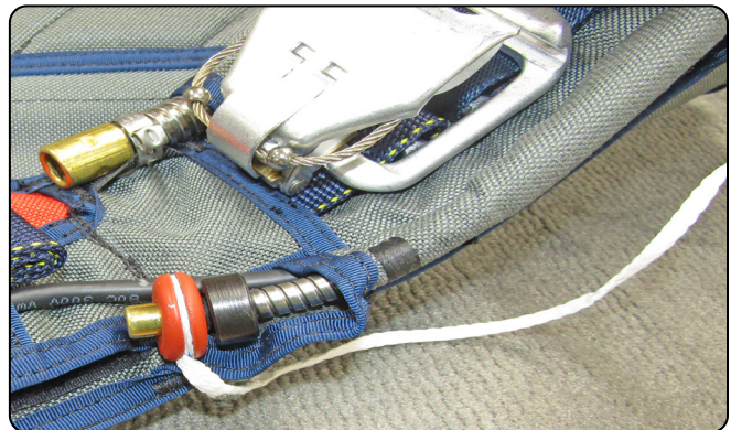
6.1.3.3 Fitting the grommet.
